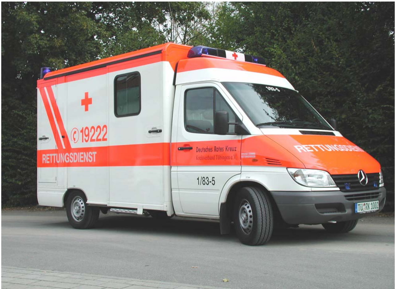
Abbildung 01: RTW des DRK Tübingen nach DIN EN 1789 Typ B
