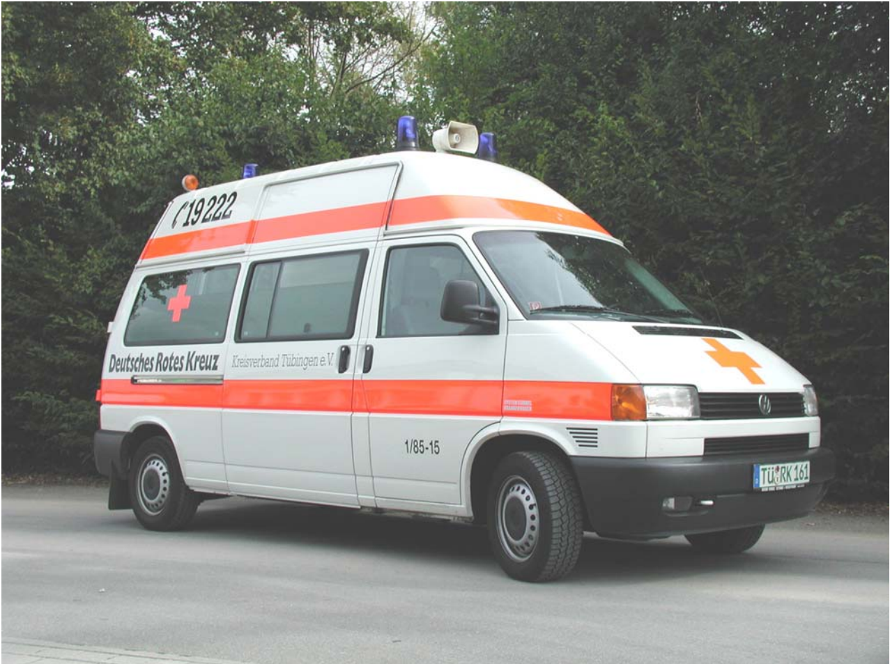
Abbildung 03: KTW des DRK Tübingen nach DIN EN 1789 Typ A
